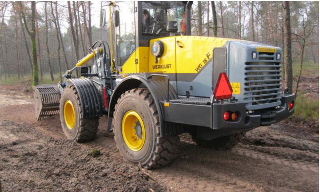
Hoge bodemvrijheid door doordacht knikpunt-systeem.
