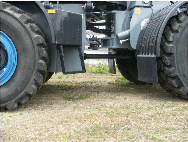
Hoge bodemvrijheid door doordacht knikpunt-systeem.
